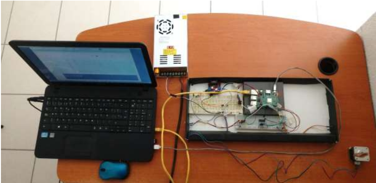
Figura 35. Vista completa de la estación de trabajo (PC, placa Raspberry Pi, fuente, actuador, driver puente H y elementos electrónica modular).
