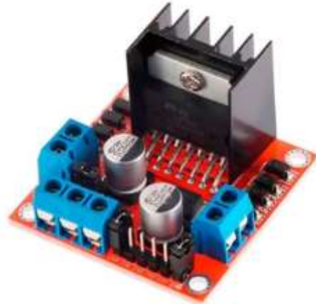
Figura 27. Driver L298N Puente H.
