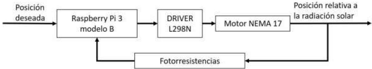
Figura 31. Sistema de control en lazo cerrado del sistema mecatrónico de seguimiento.
